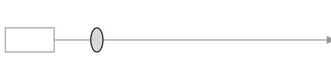
Afbeelding E2. Links weer de projector, maar nu gaat het licht eerst door een bol waterzakje, voordat het (eventueel) een beeld vormt op de verplaatsbare wand.
