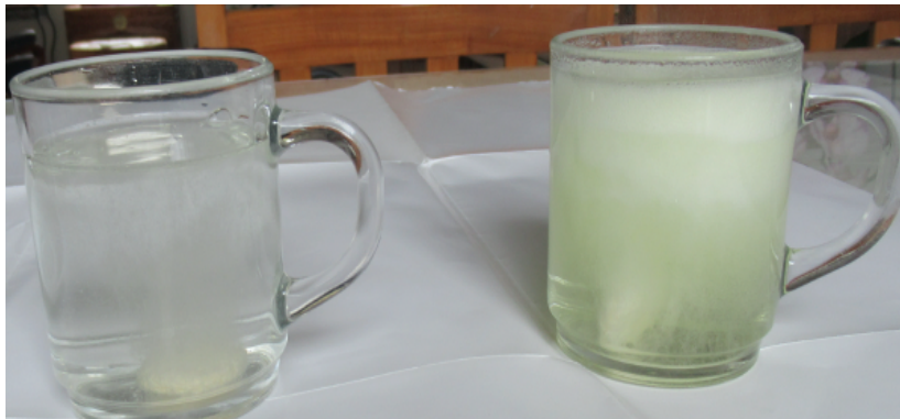
Figuur 1 Oplossen van een bruistablet met Vitamine C in koud (links) en in heet (rechts) water.
