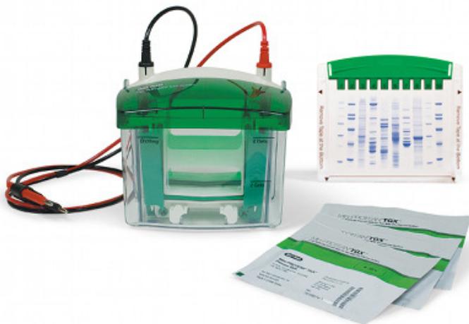
Figuur 2. Een opstelling voor gelelektroforese.
